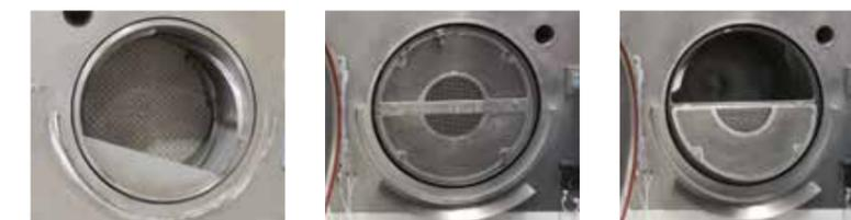
Il cestello è intercambiabile per poter scegliere il diametro dei fori, realizzato su misura in base alle vostre esigenze. Il caricamento dei pezzi avviene manualmente attraverso la porta esterna. Lo svuotamento del cestello avviene automaticamente con l'ausilio di listelli per il rotolamento che si trovano all'interno dello stesso.
